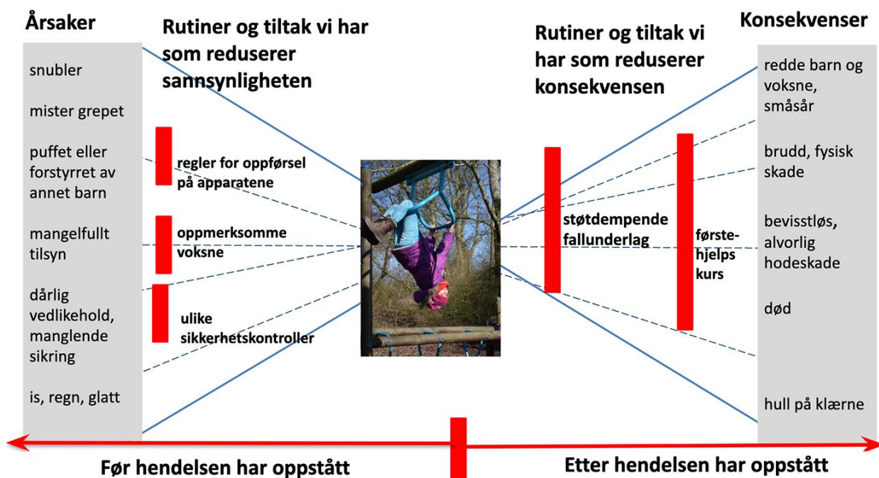
Figur 3. Eksempel på sløyfediagram som illustrerer gangen i en hendelse og som kan være til god hjelp for å skille mellom tiltak som reduserer sannsynligheten for at en hendelse skjer, og tiltak som reduserer konsekvensen dersom hendelsen likevel skjer. Figuren er hentet fra Trondheim kommune.
